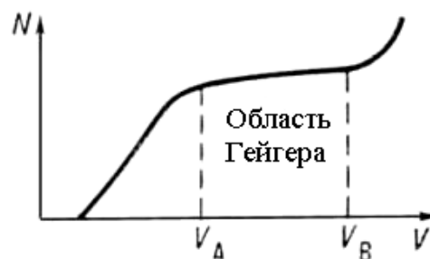
Рис. 4. Счетная характеристика счетчика Гейгера – Мюллера
